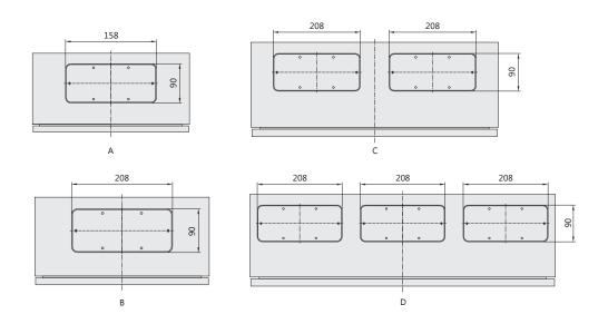
Nota: El grosor del panel de instalación podrá modificarse en función de sus exigencias específicas. (Grosor máx. 2.0mm). El cierre con barra de enganche está disponible para NXW5 de un ancho superior a 800mm.
